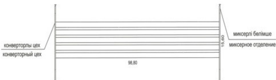
Өту галереясының сұлбасы Схема переходной галереи
